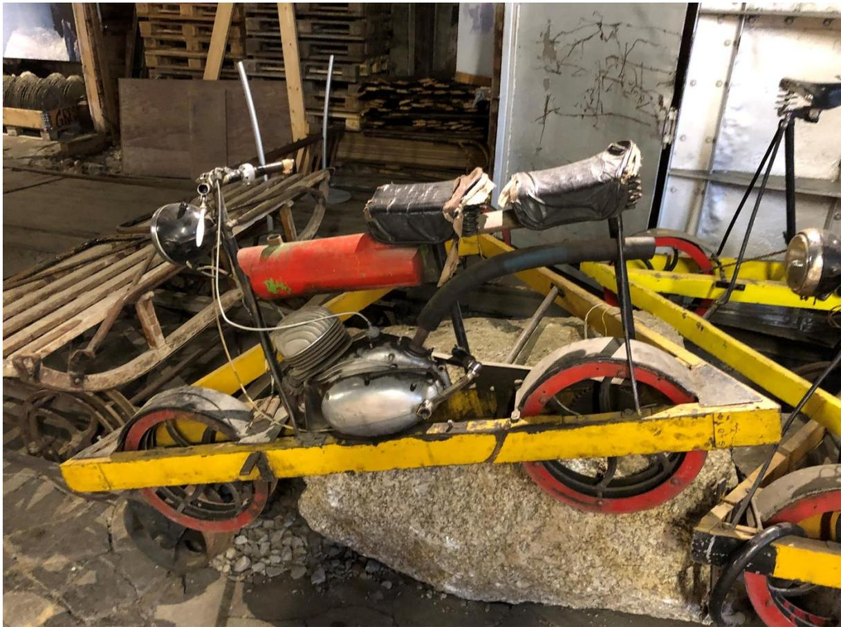
Zur Streckenerkundung wurden Fahrradraisinen oder solche Schienenmopeds eingesetzt.
