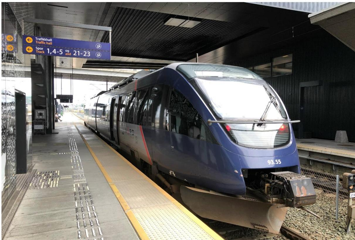
Den Personenverkehr betreibt SJ Norge AS mit diesen Triebwagen. Da die Gegend entlang dieser Strecke ab Hell sehr dünn besiedelt ist, reicht die Kapazität in jedem Fall aus. Mit Fördermitteln der EU wird die Strecke derzeit ausgebaut und aufgewertet. Nachdem Die Achslast auf 22,5 to. erhöht und die Trassenführung
