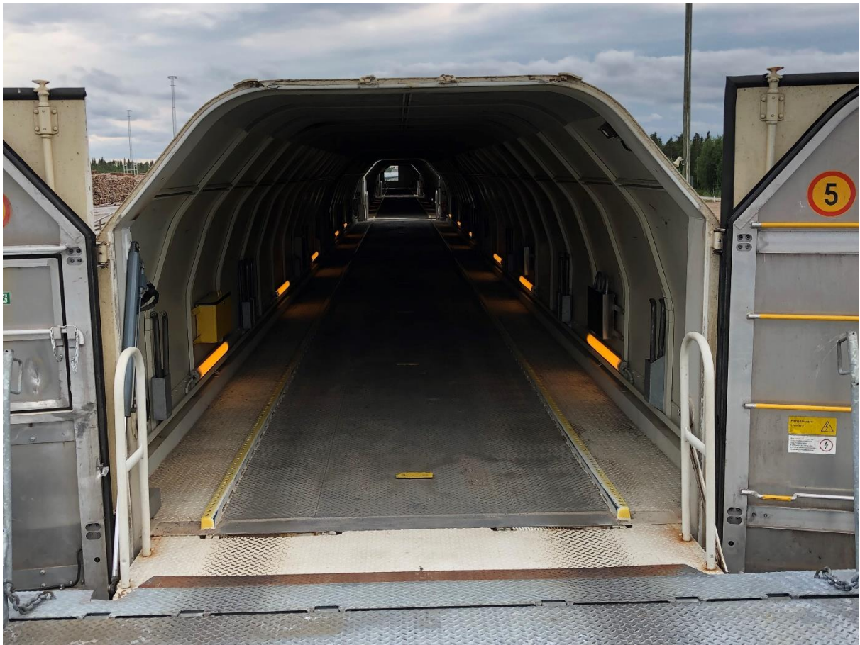
Blick in die obere Etage der geschlossenen Autotransportwagen.
