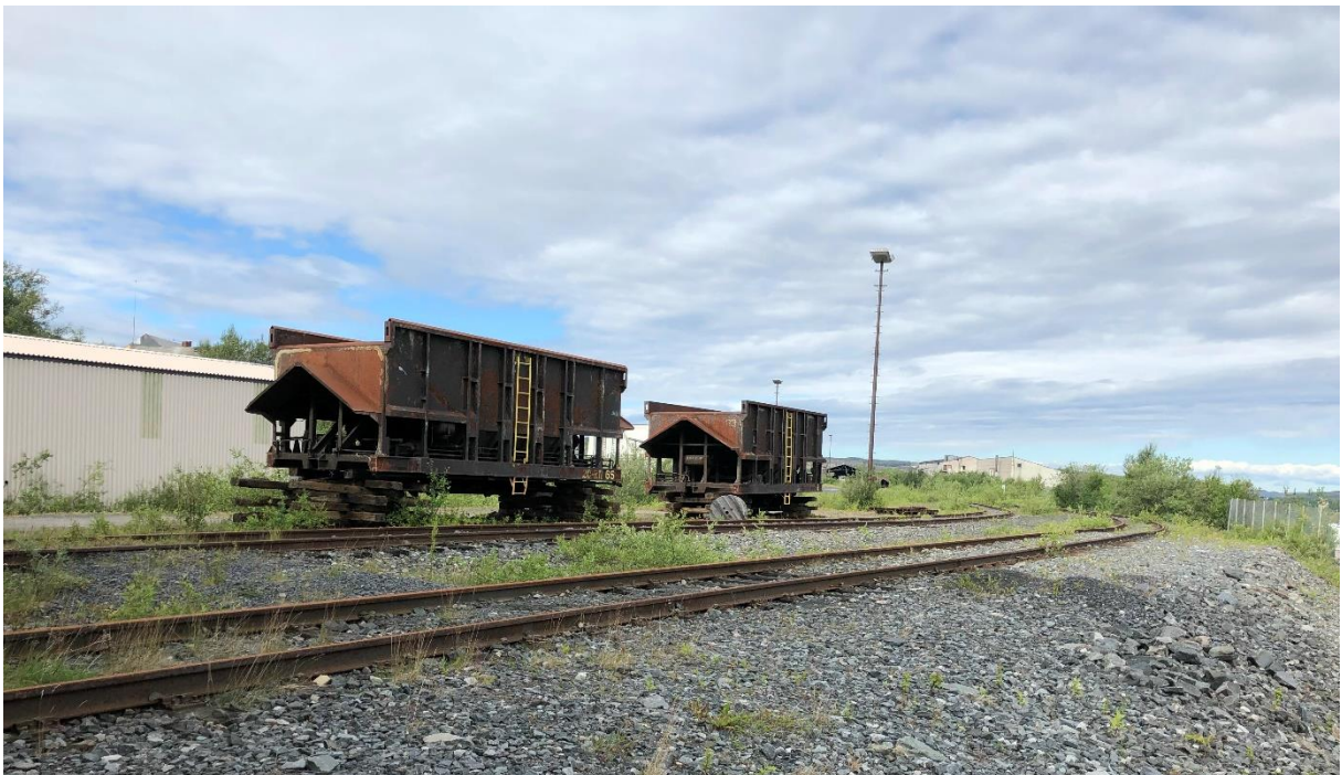
An der Einfahrt zu den Entladeanlagen in Kirkenes befanden sich zwei Wagenkästen ohne Fahrgestell aufgebockt neben den Gleisen.
